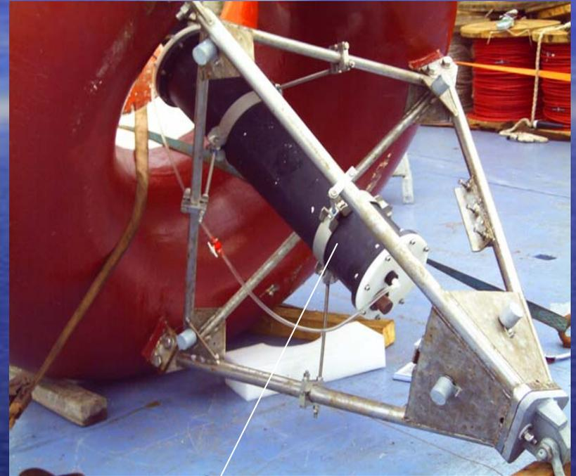
Capteur CO<sub>2</sub> fabriqué, étalonné
